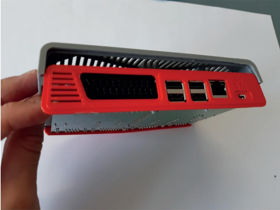
Ensuite, rabattez le PCB avec le cache arrière bien au fond de la fente du casing haut, il est possible que ça claque un peu. Quand c'est fait vérifiez bien que tout est bien positionné (cache avant, bouton on/off).
