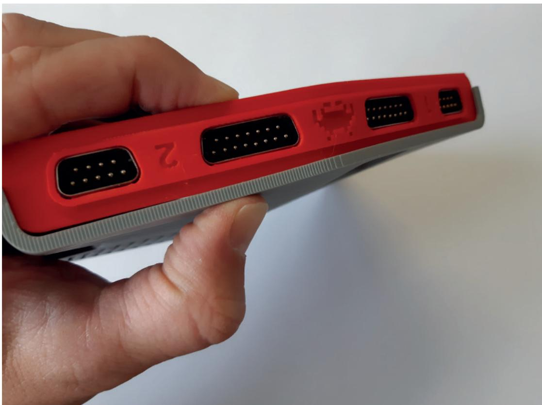
Une fois les 4 crochets enclenchés, l'écart entre le casing haut et le cache avant doit être parfaitement constant:
